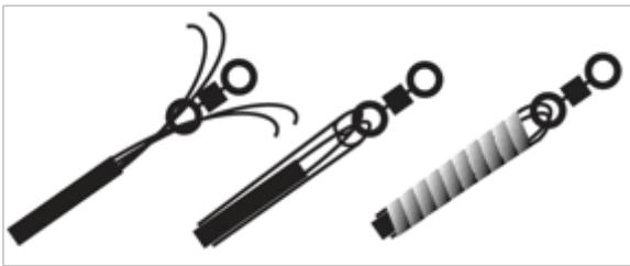
Pele la chaqueta del cable y corte todas las fibras hasta el final de la chaqueta, dejando solamente los elementos de refuerzo de aramida.
