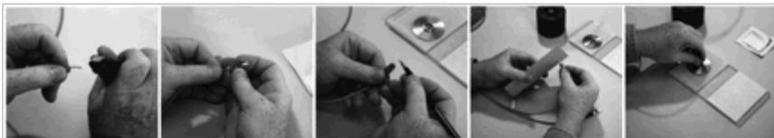
El proceso de terminación es parecido para todos los tipos de conectores adhesivo/pulido. Debe comenzar preparando el cable, pelando la chaqueta exterior y cortando los elementos de refuerzo. Luego, debe pelar la fibra con una herramienta especial que remueve el recubrimiento plástico sin dañar la fibra. Entonces debe limpiar la fibra y dejarla a un costado. Debe aplicar el adhesivo en el conector o en la fibra, y luego la fibra se inserta y se crimpa al cuerpo del conector.
